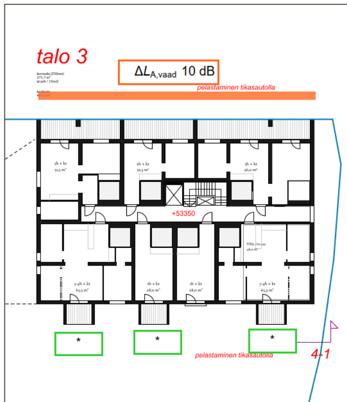
Kuva 5. Talon 3: Lasitettujen parvekkeiden äänitasoero vaatimukset \Delta L_{A,vaad} . Vihreällä laatikolla (*) merkityillä parvekkeilla ohjearvotaso täyttyvät tavanomaisella lasituksella, eikä parvekkeiden meluntorjuntaa tarvitse mitoittaa erikseen.
